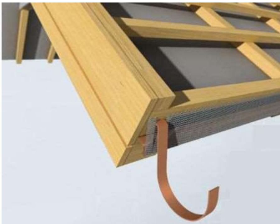
Laťování na štítě - celkový pohled (včetně žlabového háku, polypropylenového větracího pásu na větrací mezeře a okapnice)
