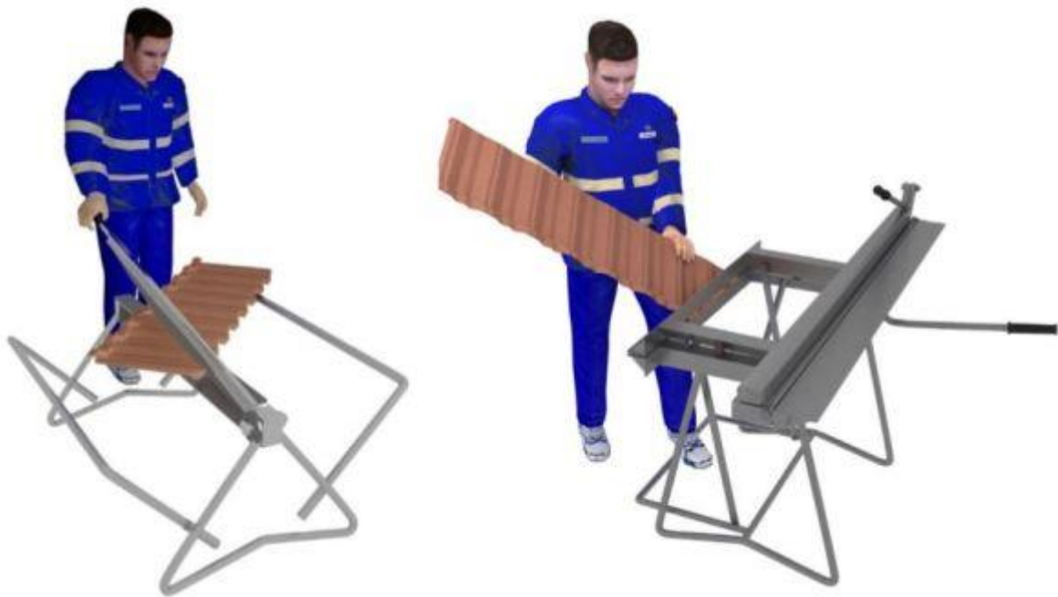
Stříhání a ohýbání šablony na nároží pomocí nůžek a ohýbačky
