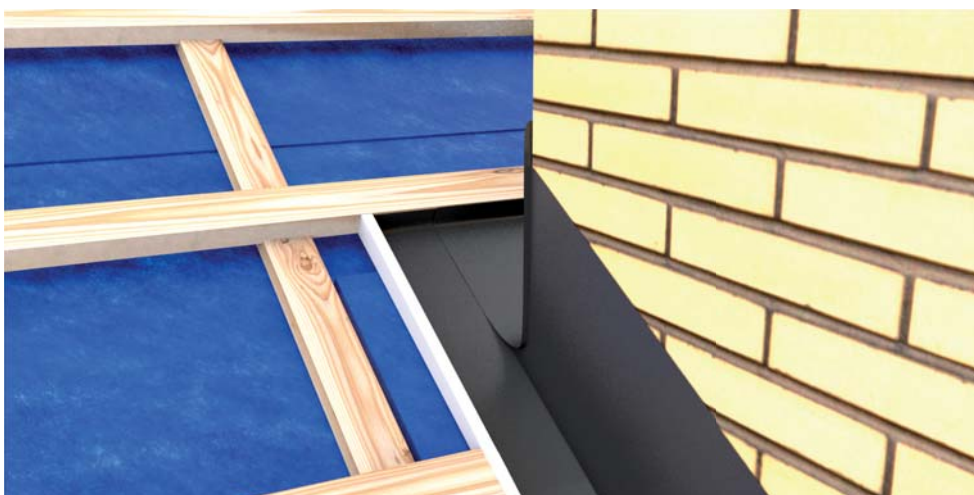
Zadní díl lemování komínu je potřeba vyprofilovat tak, aby mohl být uchycen do čela první latě za komínem.
